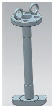
图4 高压涡轮转子专用分解工装
