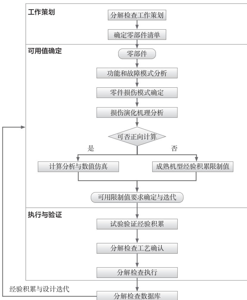
图1 分解检查工作流程
