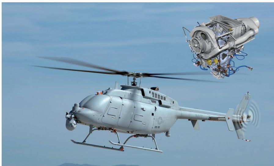
图3 MQ-8C无人机及M250-C涡轴发动机
