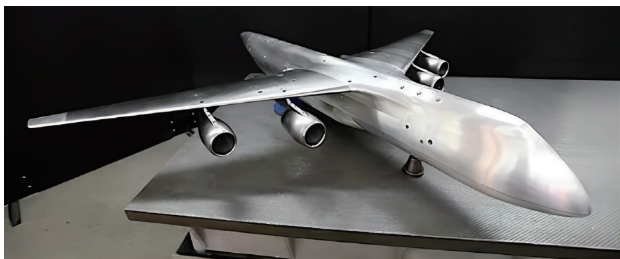
图4 “大象”运输机风洞模型
