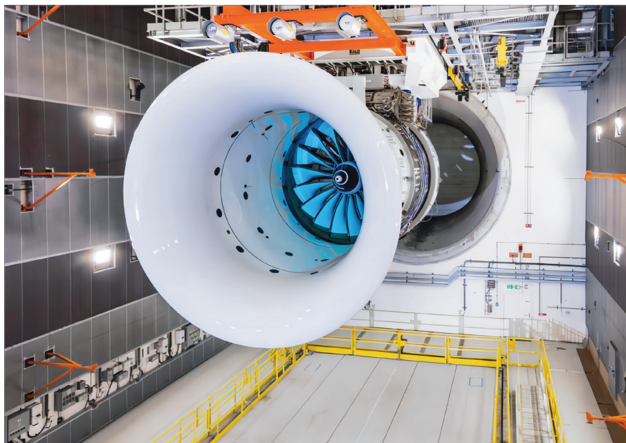
罗罗公司“超扇”技术验证机在80号试车台完成首次试车
