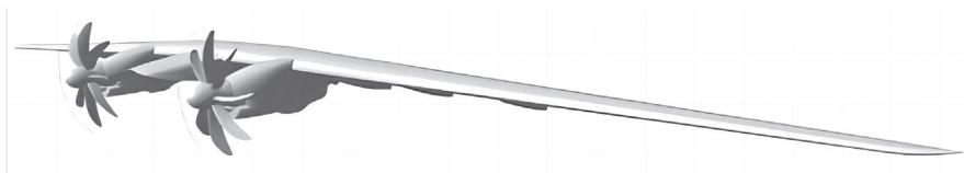
高展弦比机翼将由复合材料经由高压釜工艺制成
