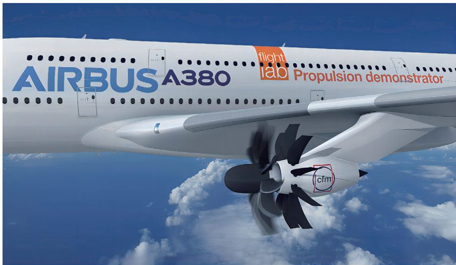
开式转子发动机飞行试验（来源：空客公司）
