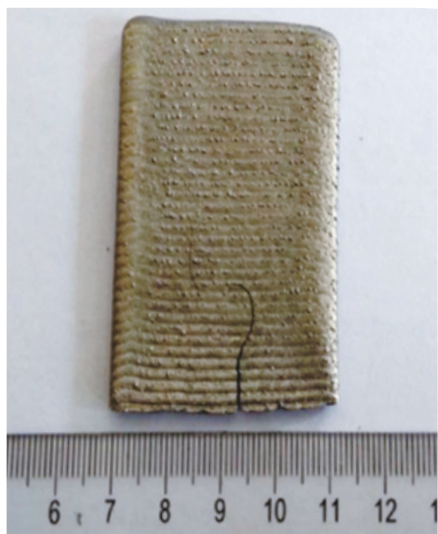
图3 增材制造中的开裂问题
