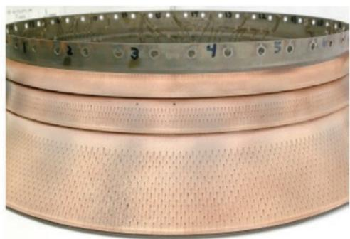
图7 GENx的多斜孔火焰筒
