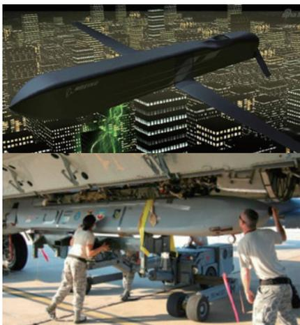
先进反电子设备高功率微波导弹
