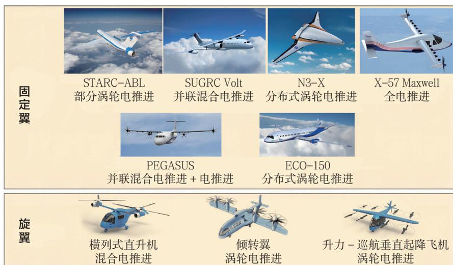
NASA电气化飞机构型
