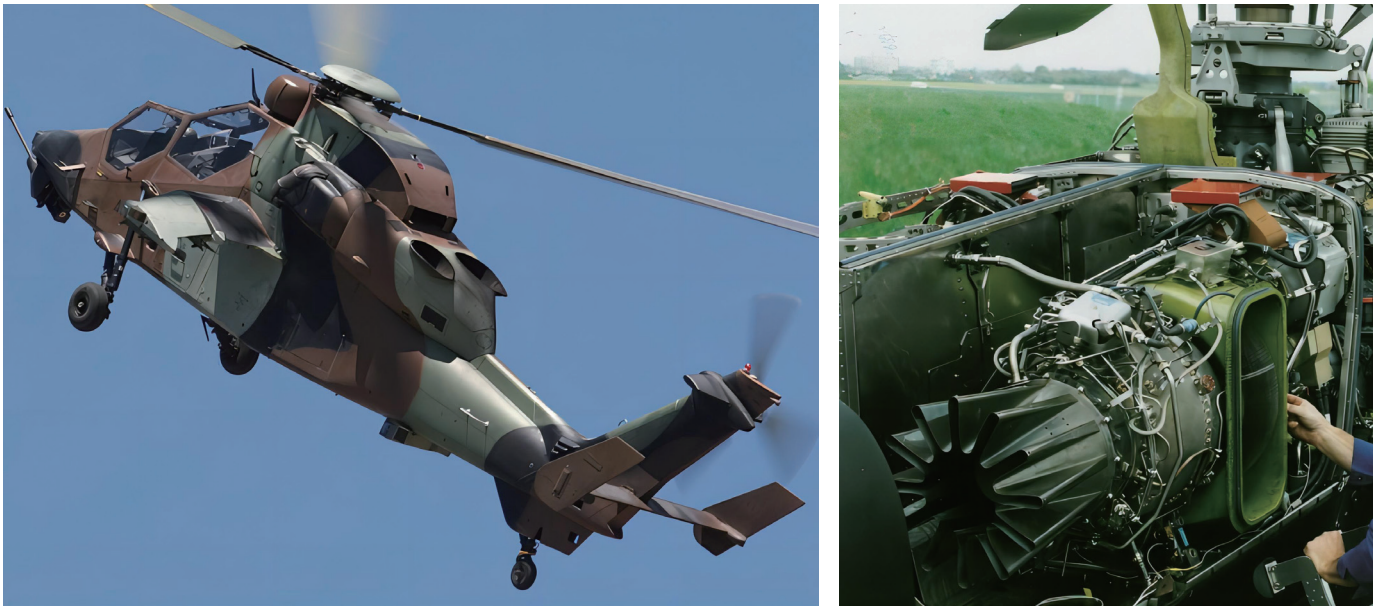
图3 “虎”直升机的排气装置采用波瓣喷管的红外抑制器
