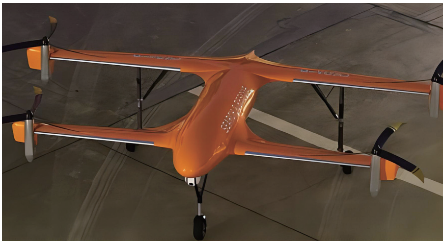
吉凯恩公司的采用氢燃料电池动力的小型地面演示验证飞机
