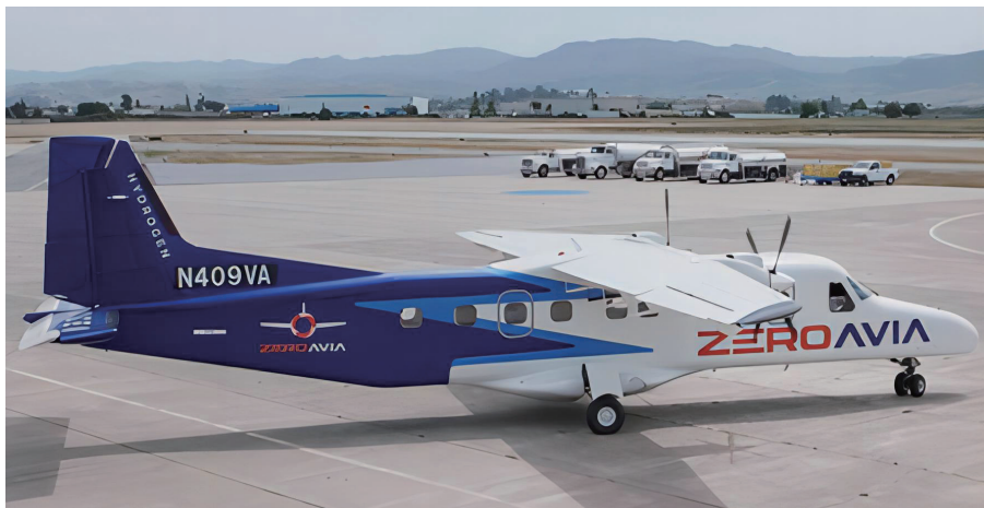
ZeroAvia基于多尼尔228飞机改装的ZA600氢燃料电池动力验证机
