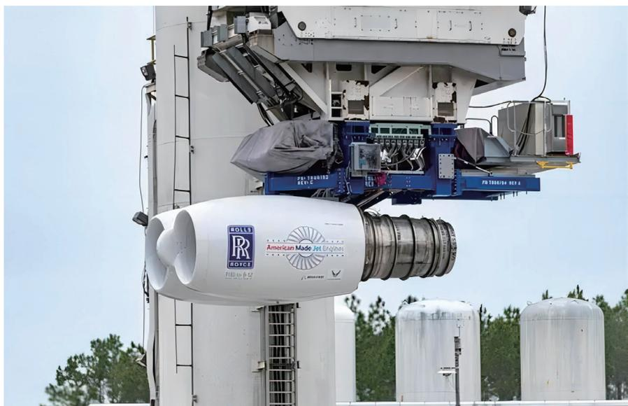
罗罗公司测试用于B-52H轰炸机换发项目的F130发动机
