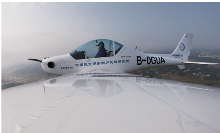
80kW级混合动力系统装SA60L飞机进行飞行试验
