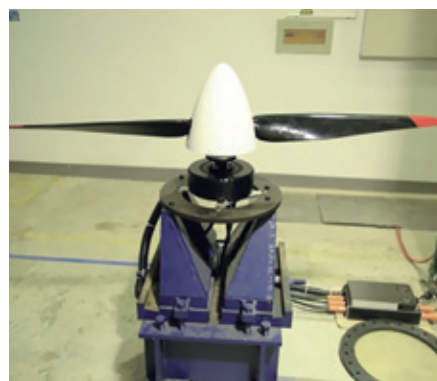
电推进子系统带桨试验
