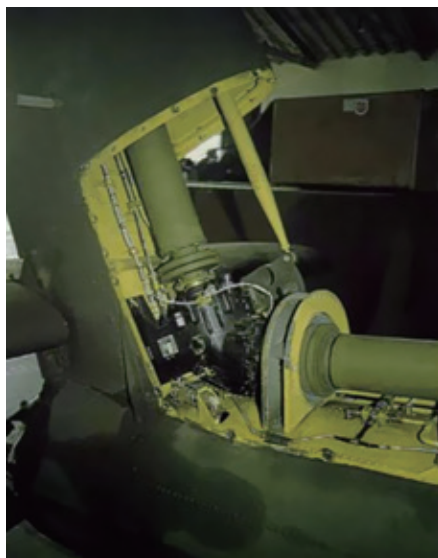
AH-64直升机使用的脂润滑中间减速器
