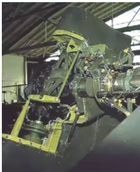
AH-64直升机使用的脂润滑尾减速器
