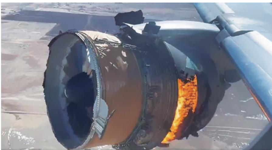
图1 叶片断裂对发动机造成损伤
