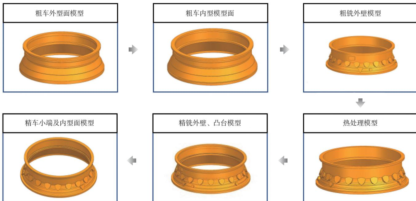
图2 机匣工艺仿真模型
