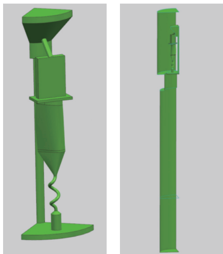
(a) 浇注系统UG建模 (b) 浇注系统1/4模型
