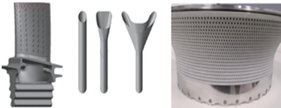
图4 超快激光加工典型零部件
