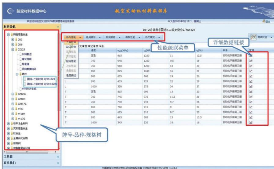
图1 航空发动机材料数据库软件界面布局
