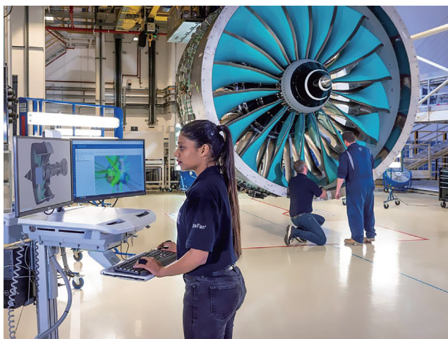
2022年7月，“超扇”发动机技术验证机进入组装阶段
