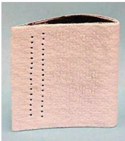
图7 制造有EBC的导叶
