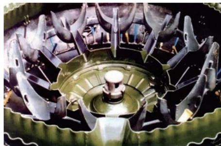
图5 新月形沙丘形态及沙丘驻涡火焰稳定器
