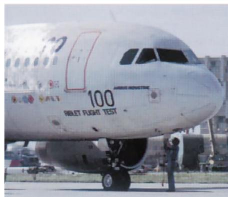
图1 鲨鱼皮体表沟槽形态和具有仿生表面贴膜的飞机
