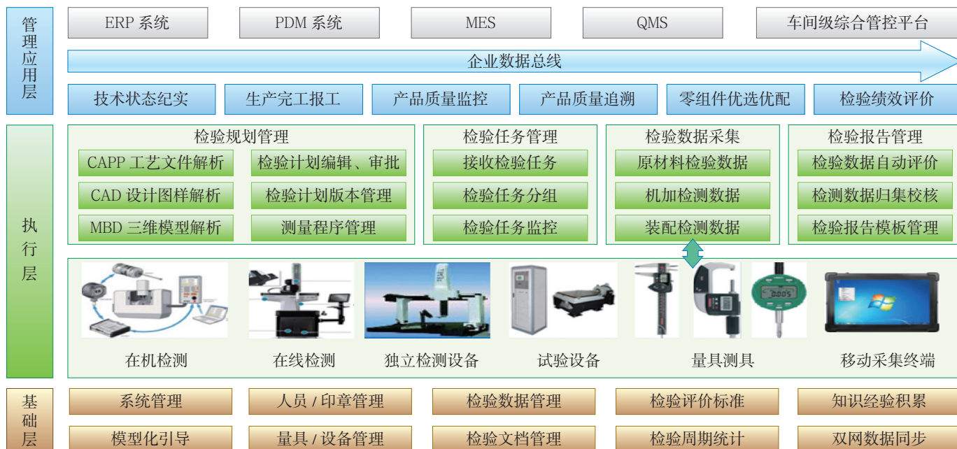
数字化检测系统总体构架
