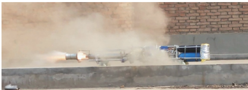
图8 西北工业大学研制的PDRE地面演示验证样机
