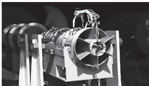
图9 中国航天科工集团第三研究院31所设计的六管并联PDE照片
