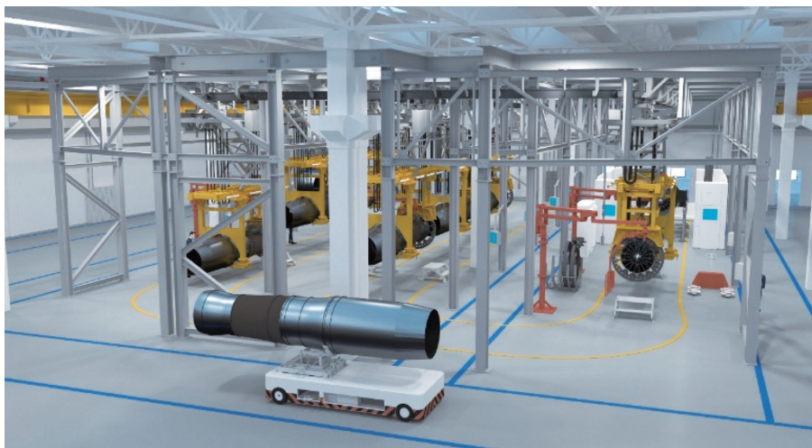
脉动装配生产线上部吊装系统总览
