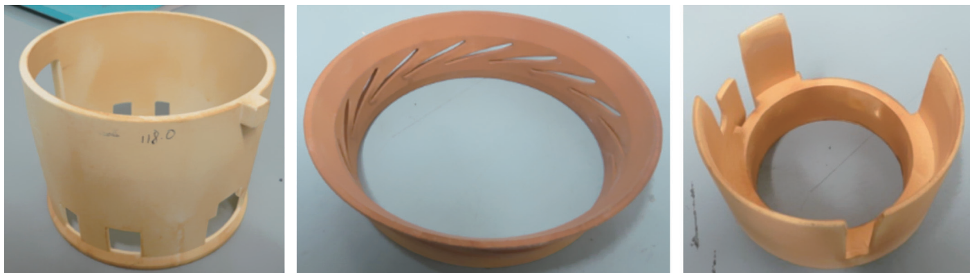
图3 环状复杂薄壁型芯
