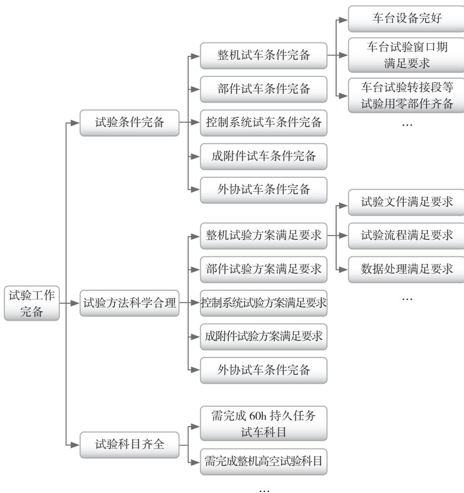
图2 成功树架构（试验部分）
