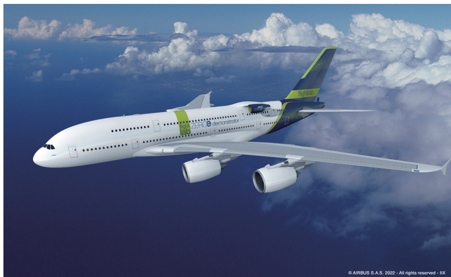
空客与CFM国际公司改装A380飞机作为氢燃料发动机飞行测试平台
