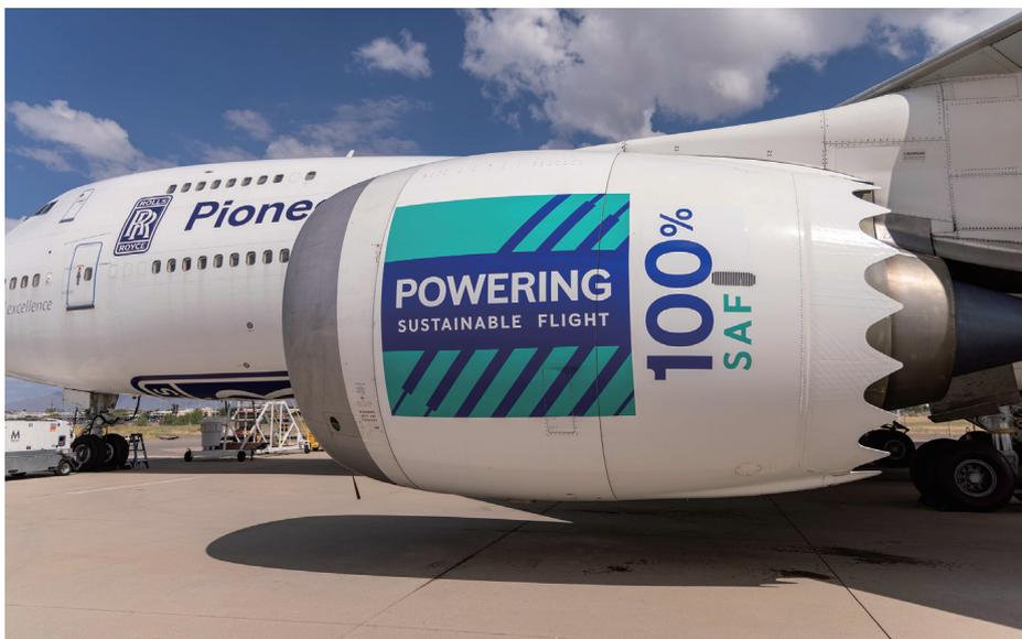
使用100%SAF的遛达1000发动机在波音747平台进行飞行测试（来源：罗罗公司）
