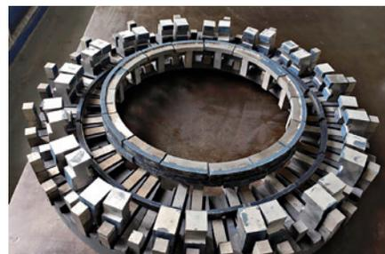
图6 钎焊夹具实物
