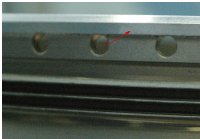
图3 4 ~ 9级盘后止口试车后状态
