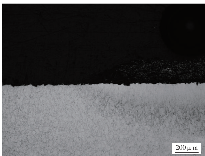
图5 FGH96基材表面NiCrAlY涂层腐蚀后组织形貌
