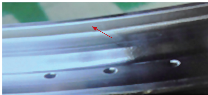
图8 盘前封严挡板止口修复
