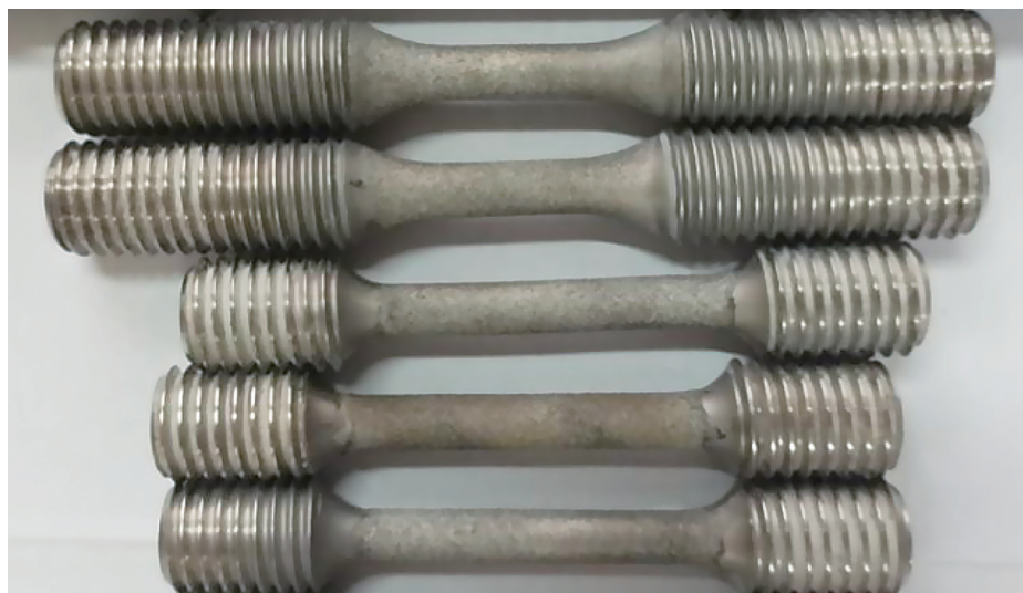
图4 带有涂层的力学性能试样
