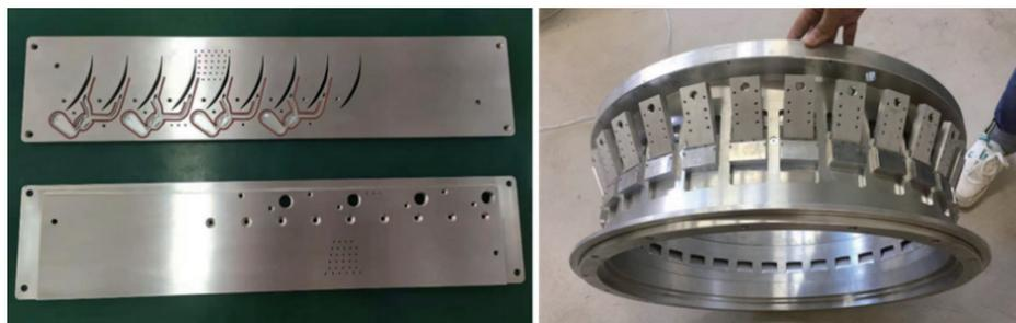
流体振荡器与平面叶栅端壁的一体化耦合结构 流体振荡器与转子机匣的一体化耦合结构
