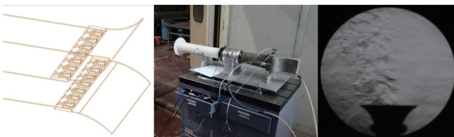
流体振荡器与二维气动矢量喷管的一体化耦合结构
