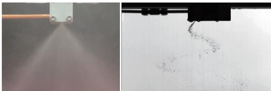
新型燃料喷射装置产生的平均液雾场
