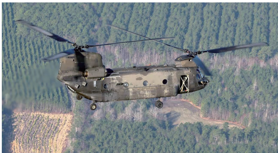
图7 CH-47F换装T408飞行试验
