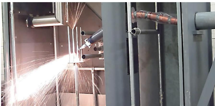
图5 蛇形臂机器人进行激光切割
