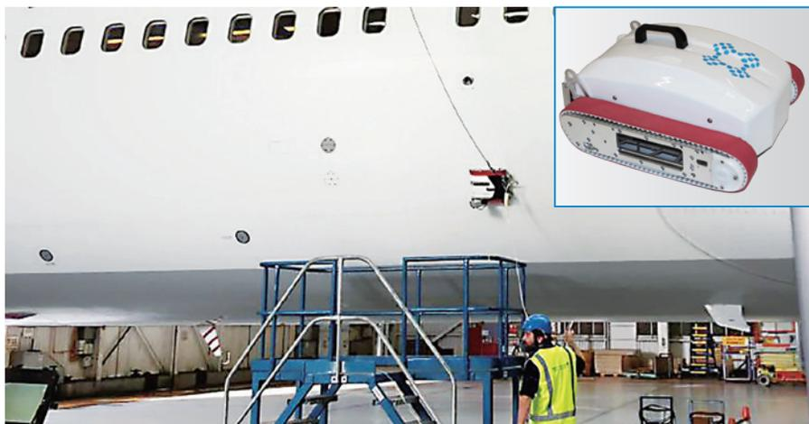
图1 Invert爬壁机器人
