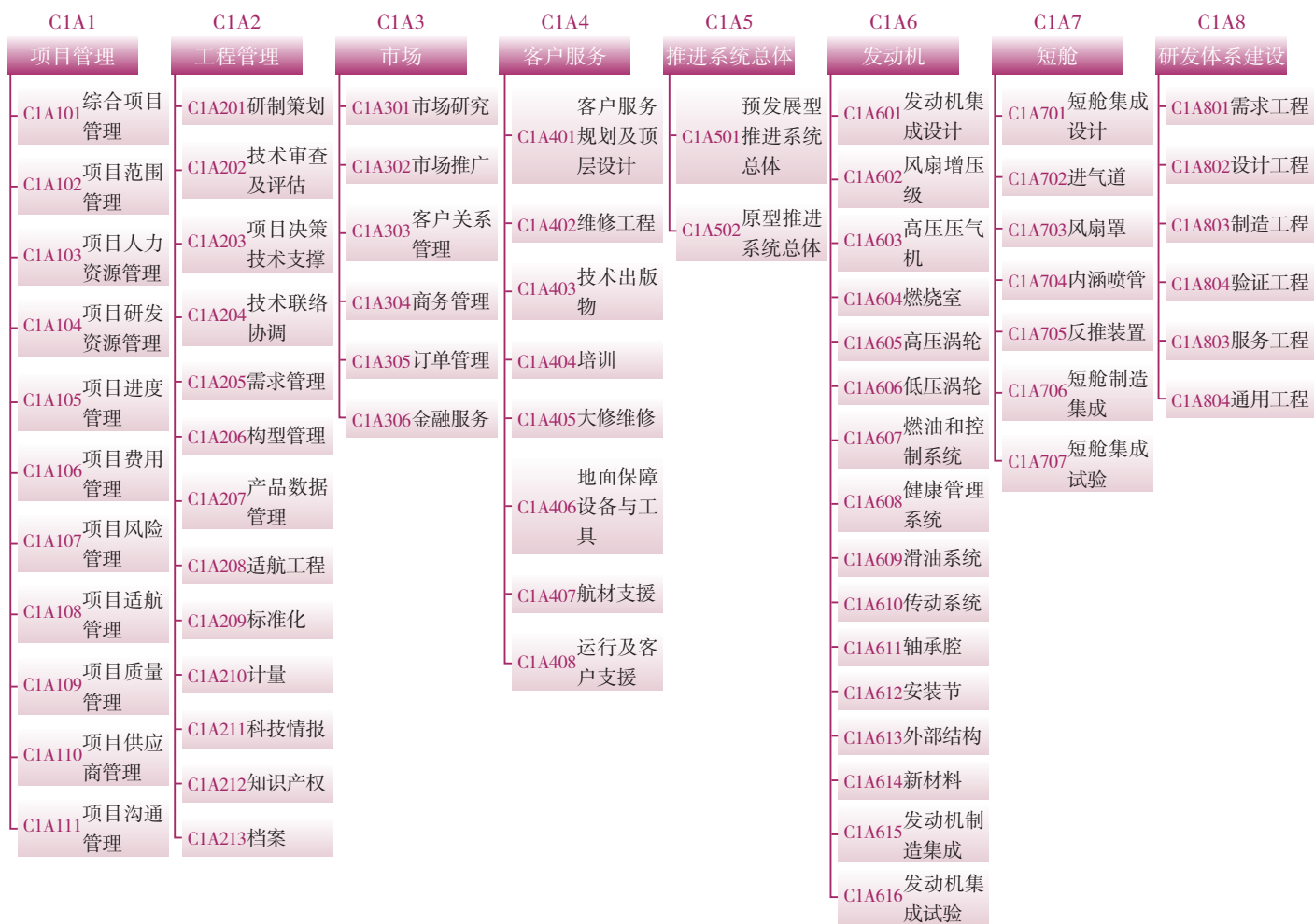
图1 航空发动机研制的顶层WBS框架
