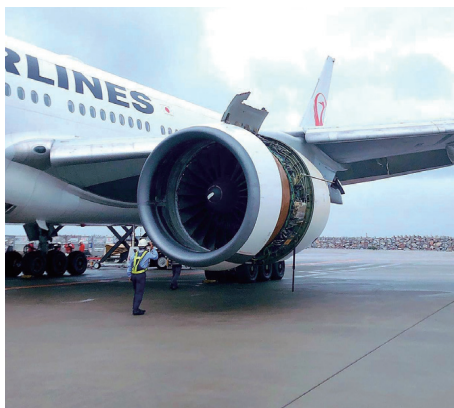
(a) JL904 外侧风扇整流罩丢失
