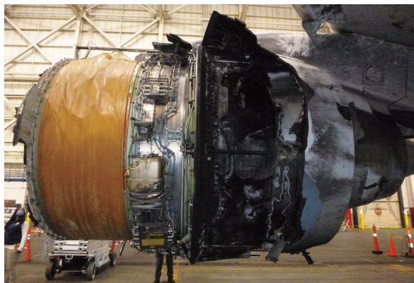
图2 发动机后部被火烧过
