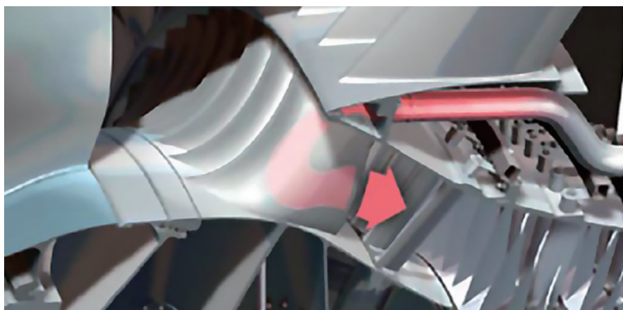
图7 遑达XWB分流环引入热空气
