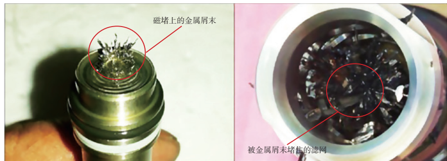
图2 吸满屑末的磁堵与被屑末堵住的油滤
