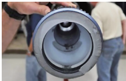
图4 低压涡轮轴断裂处的断口
