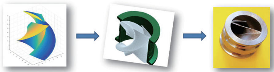
图2 增材制造在异形组合喷嘴加工的应用
