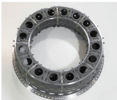
图3 DLD火焰筒部件几何模型和全环成品实物
