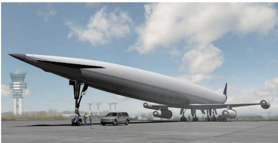
图1 LAPCAT项目A2构型高超声速飞机
