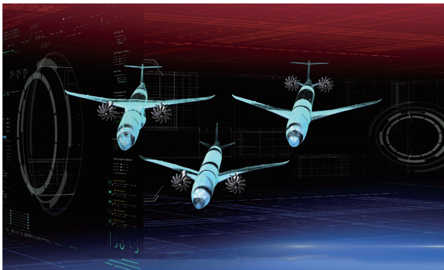
RISE 计划下开式转子发动机与飞机集成概念(来源:CFM 国际公司)
