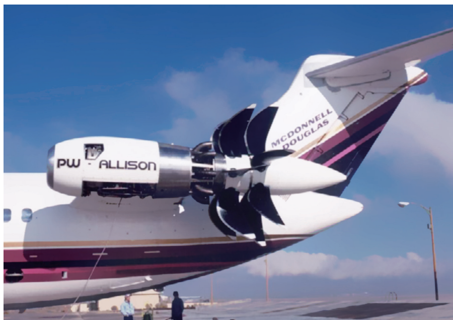
采用“推进式”构型的578 DX开式转子发动机
