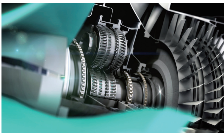
“超扇”发动机的减速齿轮箱
