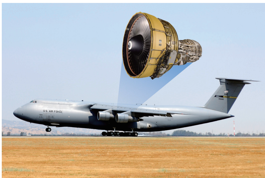
图3 C-5运输机及其动力F138-GE-100发动机
