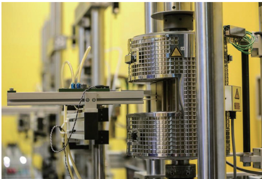
发动机材料和零件强度测试设备
