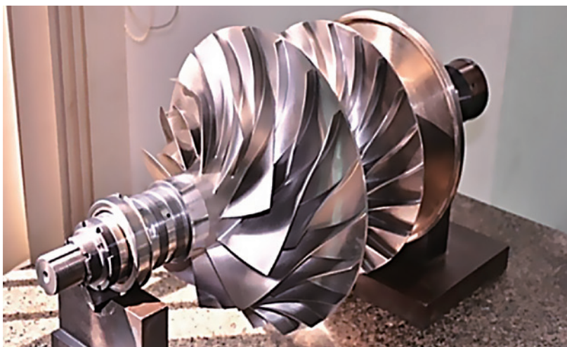
图3 涡轴16发动机双级离心压气机
