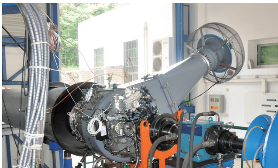
图4 涡轴16发动机车台试验
