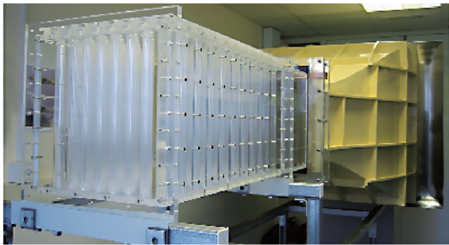
图3 SABRE 预冷器聚乙烯甲基酯试验件在低速风洞中的试验构型
