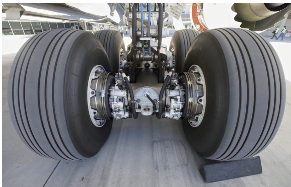
波音787飞机采用的电动起落架系统
