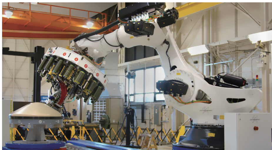
NASA正在使用可延展6.5m的机械臂对复合材料进行制造和测试
