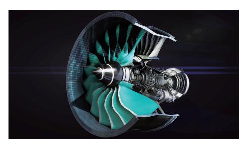
结概念设计,同时以"Advance核心机+复合材料叶片+齿轮箱"为典型特征的"超扇"发动机进展顺利,计划2025年左右可正式投入市场。
