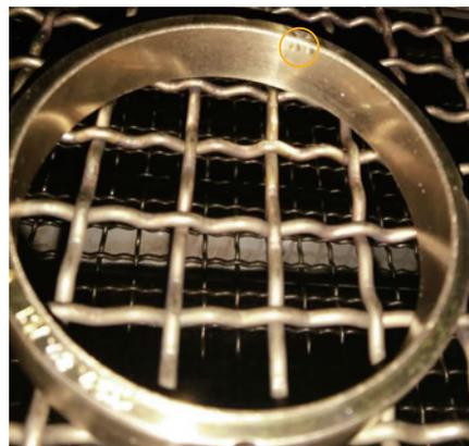
图3 组合前加热时滑油冒出
