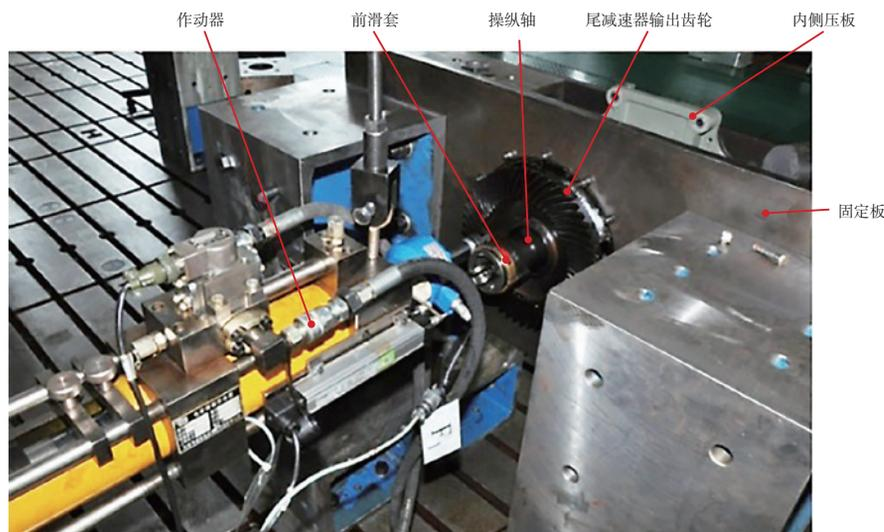
图4 前滑套自润滑性能试验
